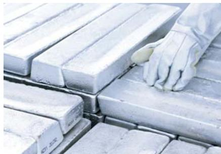
**Magnesium:** Das Metall ist drei Mal leichter als Stahl und eineinhalb Mal leichter als Aluminium, dabei gleichzeitig fest und stabil – ideale Voraussetzungen für den Leichtbau.
