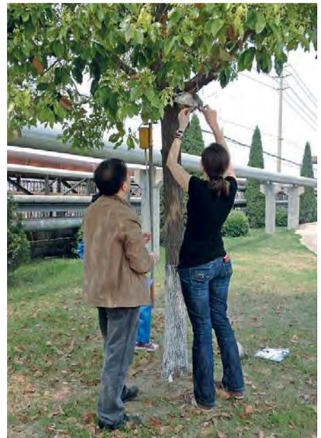
Befestigung eines Passivsammlers, um den Schadstoffgehalt in der Luft auf dem Textilfabrikgelände abschätzen zu können
