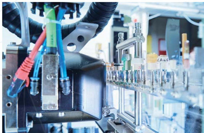
Automatischer Probenwechsler an einer HZG-Beamline am GEMS.
