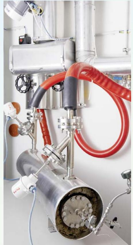
In dieser Versuchsanlage steckt ein Wasserstoff-Speicher auf Natrium-Alanat-Basis.
