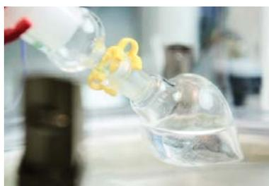
Am Rotationsverdampfer werden die Proben eingeeengt.
