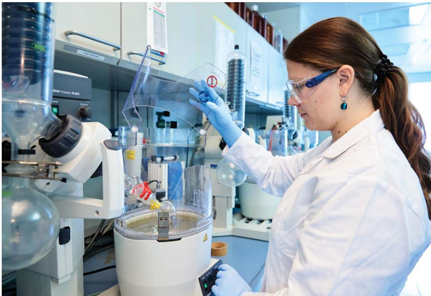
Die Doktorandin Christina Apel interessiert sich für UV-Filter und -Stabilisatoren in den Sedimenten. Die Proben müssen zunächst auftauen und mit einem Trocknungsmittel verrieben werden. Das trockene Gemisch wird anschließend in Spezialbehälter gefüllt, um eine beschleunigte Lösungsmittelextraktion durchzuführen.
