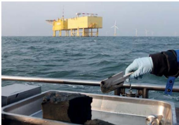
Bilder oben: Mit einem Kastengreifer wird Sediment vom Meeresboden hochgeholt.
