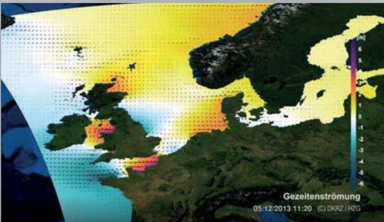
Gezeitenströmung und Wasserstand: Der Datensatz coastDat basiert auf numerischen Modellen. Das Portal liefert seit mehr als 15 Jahren wissenschaftlich basierte Daten. Es wird zum Beispiel bei Planungen von Offshore-Windparks verwendet.
