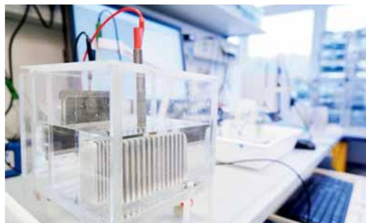
Durch die lamellenartige Struktur weist diese Elektrode eine deutlich größere Oberfläche auf.
