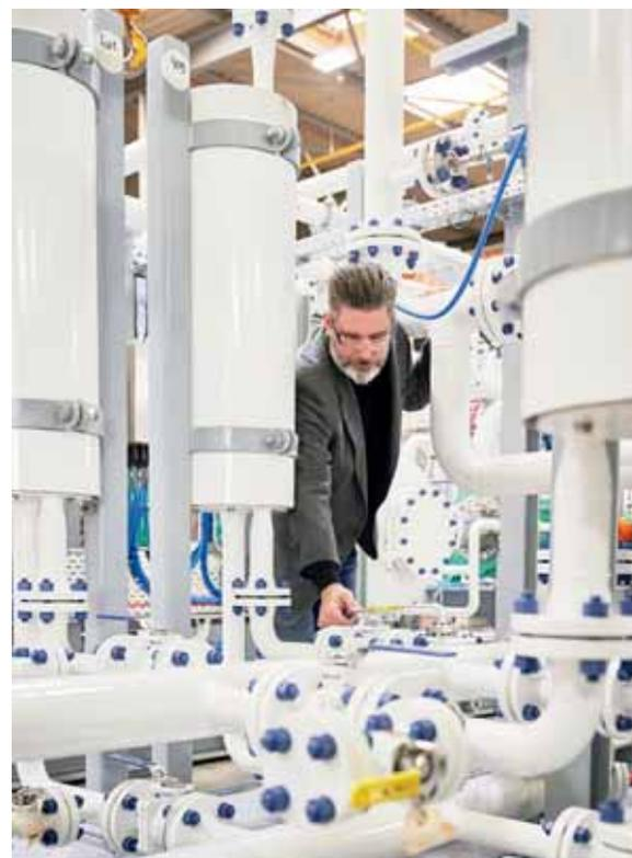
Die funkelneue Anlage wird im Werk zusammengesetzt. In den hohen weißen Behältern auf dem rechten Bild stecken die Membranen aus Geesthacht.
