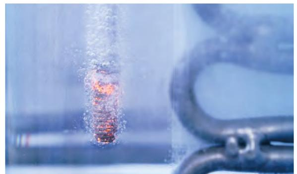
Eine Knochenschraube aus einer Magnesium-Legierung erhält eine PEO-Beschichtung im Elektrolyt-Bad. Deutlich zu erkennen sind die Funkenentladungen auf der Schraube. An den Funkenflecken oxidiert das Material und im weiteren Verlauf entsteht eine oxidkeramische Schicht, die die Schraube im Einsatz vor zu schneller Korrosion schützt.
